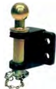
| Chape de manoeuvre et de dépannage Perçage 4 trous Ø 13 x 85,7 x 44,45 mm Traction pour rotule Ø 50 : 3,5 tonnes Traction sur axe Ø 32 : 8 tonnes
