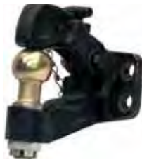
| Crochet fixe Perçage 4 trous Ø 17 40 x 90 mm Pour rotule Ø 50 ou anneau 42 x 68 PTC : 3,5 tonnes
