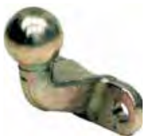
| Crochet boule Ø 50 Fixation 2 trous Ø 17 x 90 PTC : 3,5 tonnes
