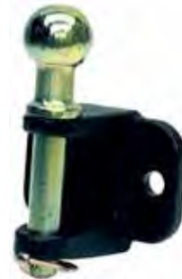
| Chape de manoeuvre et de dépannage Perçage 2 trous Ø 17 x 90 mm Traction pour rotule Ø 50 : 1,5 tonnes Traction sur axe Ø 24 : 3,5 tonnes
