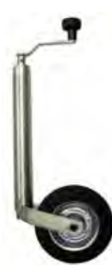
| PM 48 Roue jockey Ø48 Galet de 200 x 50mm Charge utilitaire maxi: 80 kg Poids 5 kg T-13042
