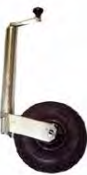
| Gonflable Roue jockey Ø48 Galet de 260 x 85mm Charge utilitaire maxi: 120 kg Poids 5 kg T-13082
